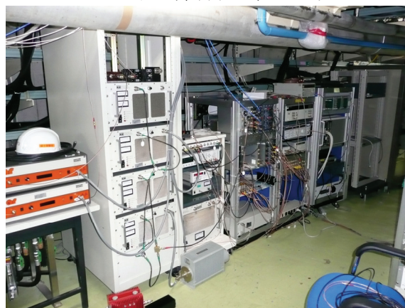
図 2-78 横方向 FB の為の RF アンプ
